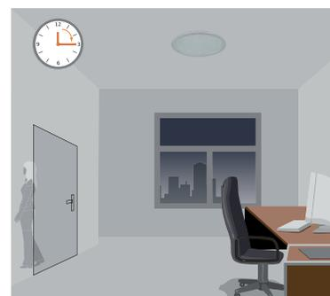
Après le temps de maintien, il s'éteint automatiquement lorsqu'aucun mouvement n'est détecté.
