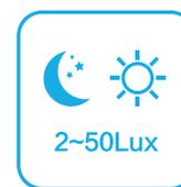
Ce capteur est un interrupteur de mouvement, qui allume la lumière lors de la détection d'un mouvement de personnes, et qui l'éteint après un temps de maintien présélectionné lorsqu'il n'y a plus personne à proximité. Un capteur de lumière du jour y est également intégré pour éteindre la lumière lorsqu'il y a suffisamment de lumière naturelle.
