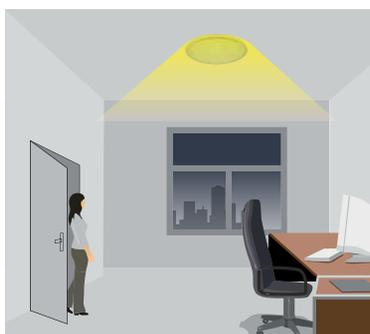
En cas d'insuffisance de lumière naturelle, le capteur allume automatiquement la lumière lorsqu'une personne entre dans la pièce.
