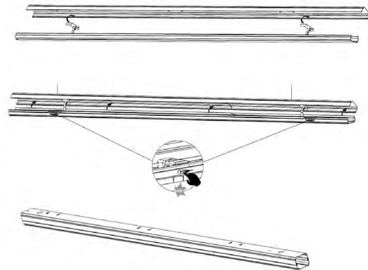
**PL** Aby uzyskać IP54 należy połączyć zakupiony panel nośny z profilem led lub maskownicą
